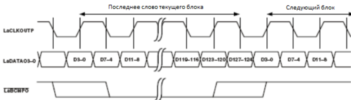
Рисунок 83 – Порт связи «а» передает порту связи «b» с завершением блока (новый блок из порта связи «а» следует немедленно после завершения первого блока)
