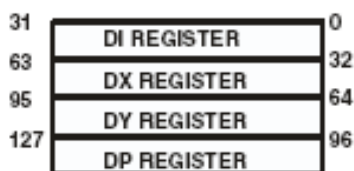
Рисунок 49 – Регистры блока управления передачей DMA
